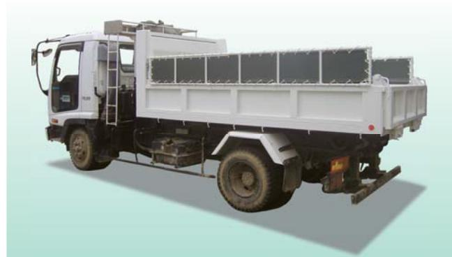
●ダンプゲート ●手動式コボレーン付き
