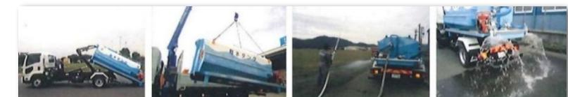
寸法 L3850×W1930×H1800mm 重量1000kg タンク容量 4000L
